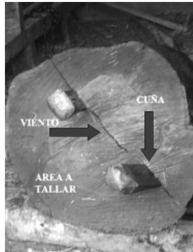
Figura 3: Partidura de tronco para tallado de batea, comunidad de Pucura.
